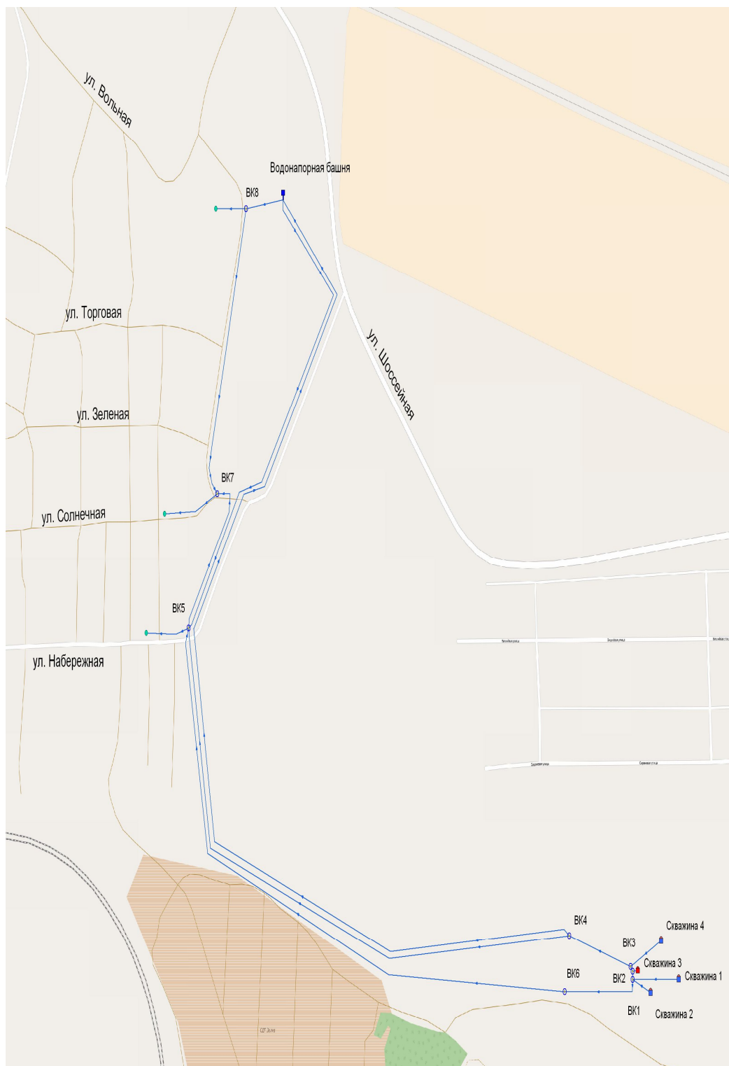
Рисунок 2.4.9.11 - План водопроводных сетей хозяйственно-питьевого водоснабжения с. Малая Царевщина (участок от водозабора в южной части села до внутриквартальных распределительных сетей)
